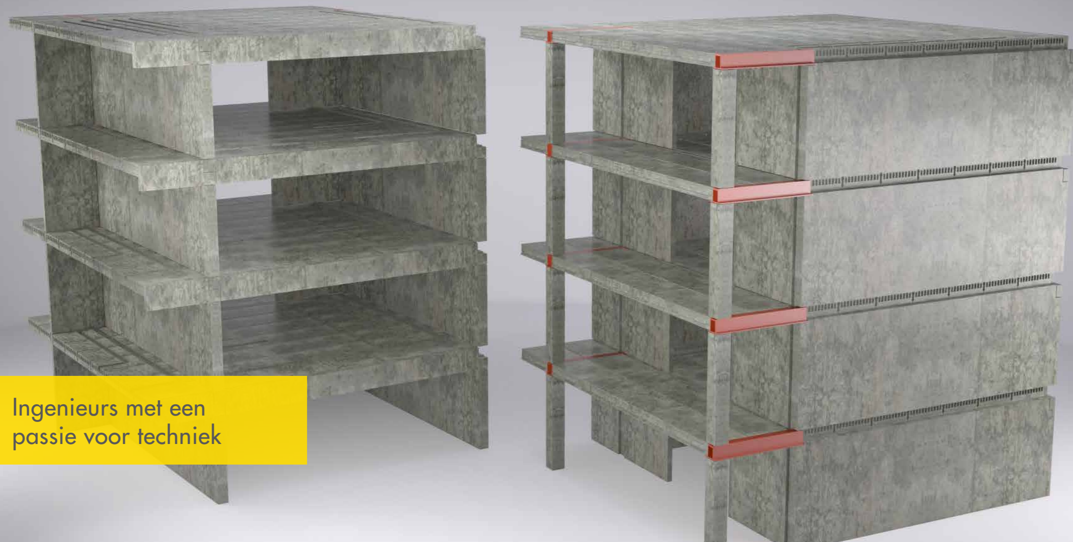
Betoncasco van een gebouw geheel opgezet in 3D, met alle aansluitingen en knelpunten direct zichtbaar.
