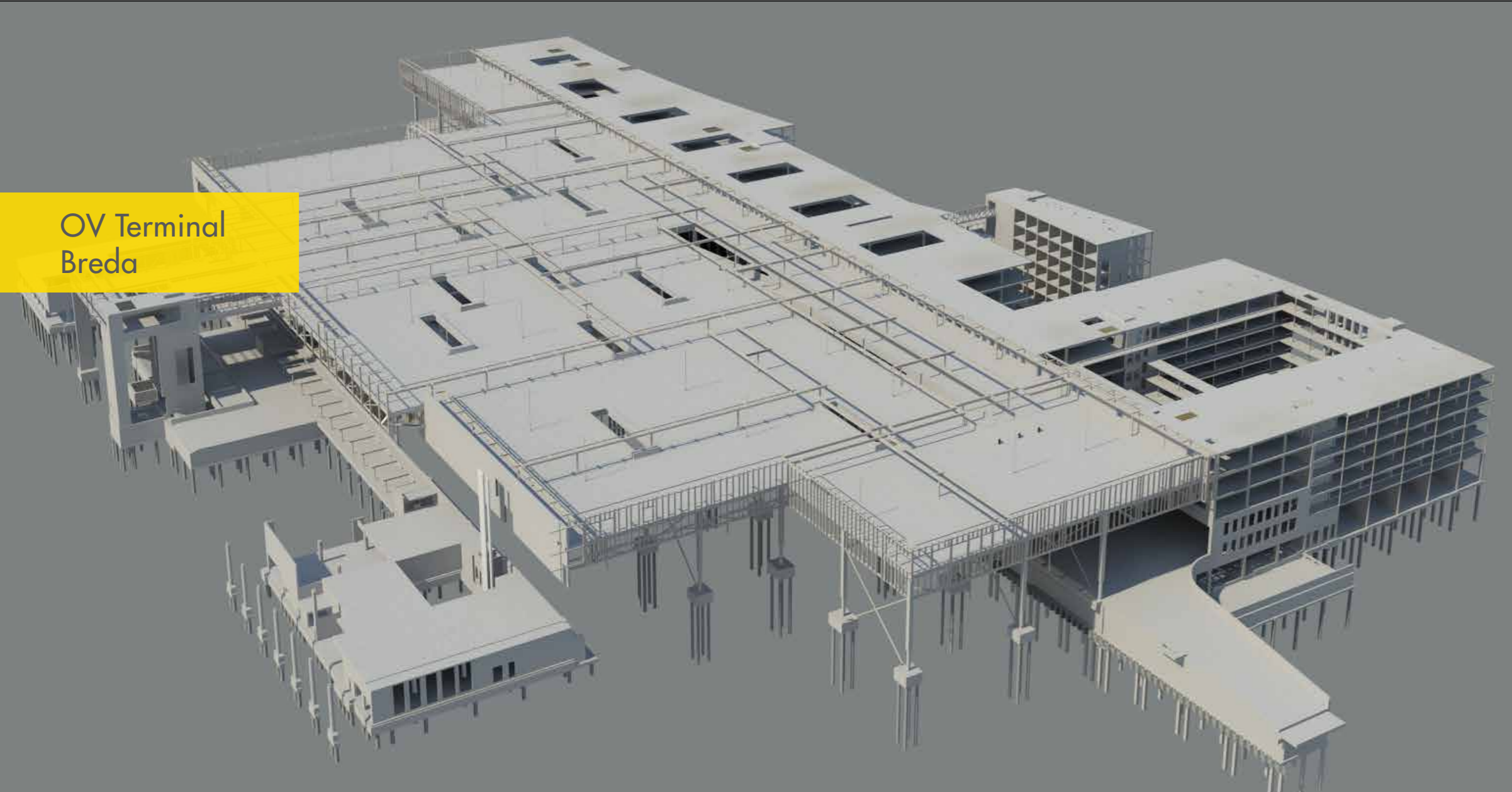
3D constructiemodel van Bartels van het noordelijke bouwdeel van de OV Terminal
